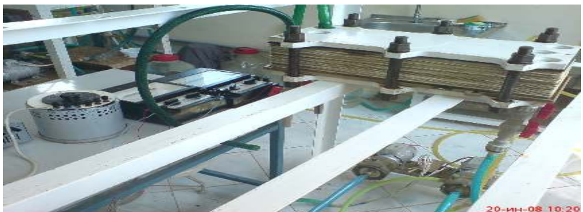
ნახ.4. ელექტროდიალიზური აპარატები აწყობილი სტენდზე
