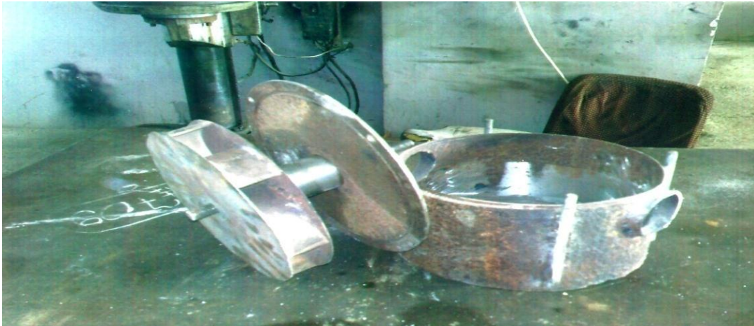
ნახ.3.2. პნევმოატრანსპორტო სისტემა დისკური გამომტანი მოწყობილობით
