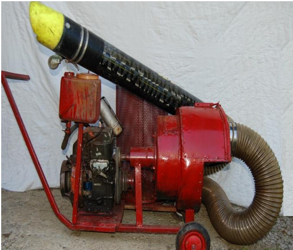
ნახ. 3.6. თხილის საკრეფი აგრეგატი გრიგალური ტიპის ვენტილატორით
