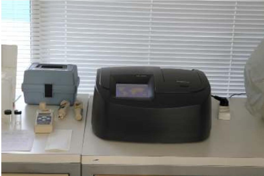
სურ.15. ბათუმის დელფინარიუმის წყლის ლაბორატორიის ხელსაწყოები: პორტატული ხელსაწყოები pH-Testr 30 და ORPTestr, EuTech-ის კალორიმეტრი და DR 5000 სპექტროფოტომეტრი
